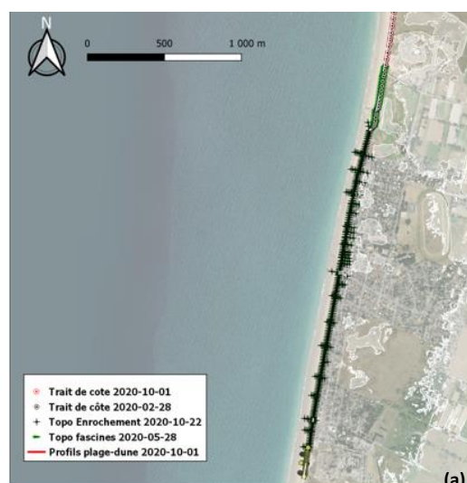
Figure 2. Représentation des données topographiques acquises par DGPS (a) et par Lidar (b).
