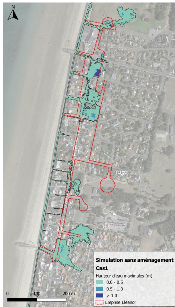
Figure 56. Hauteurs d'eau maximales pour le cas 1.
