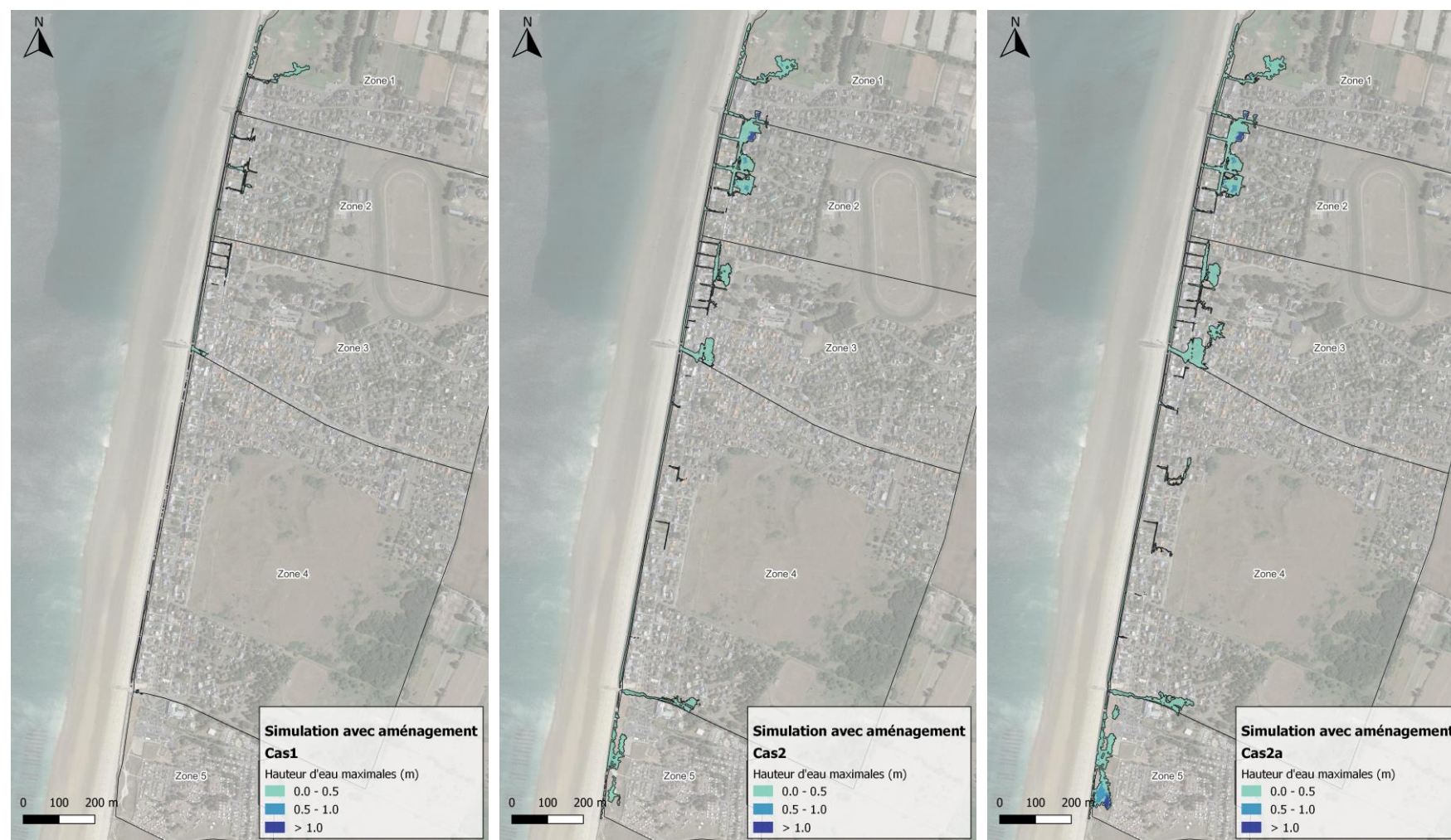
Figure 73. Hauteurs d'eau maximales pour les différents cas 1, 2 et 2a avec aménagements.
